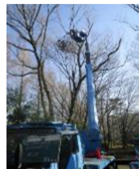
高所作業車での枝下ろし
